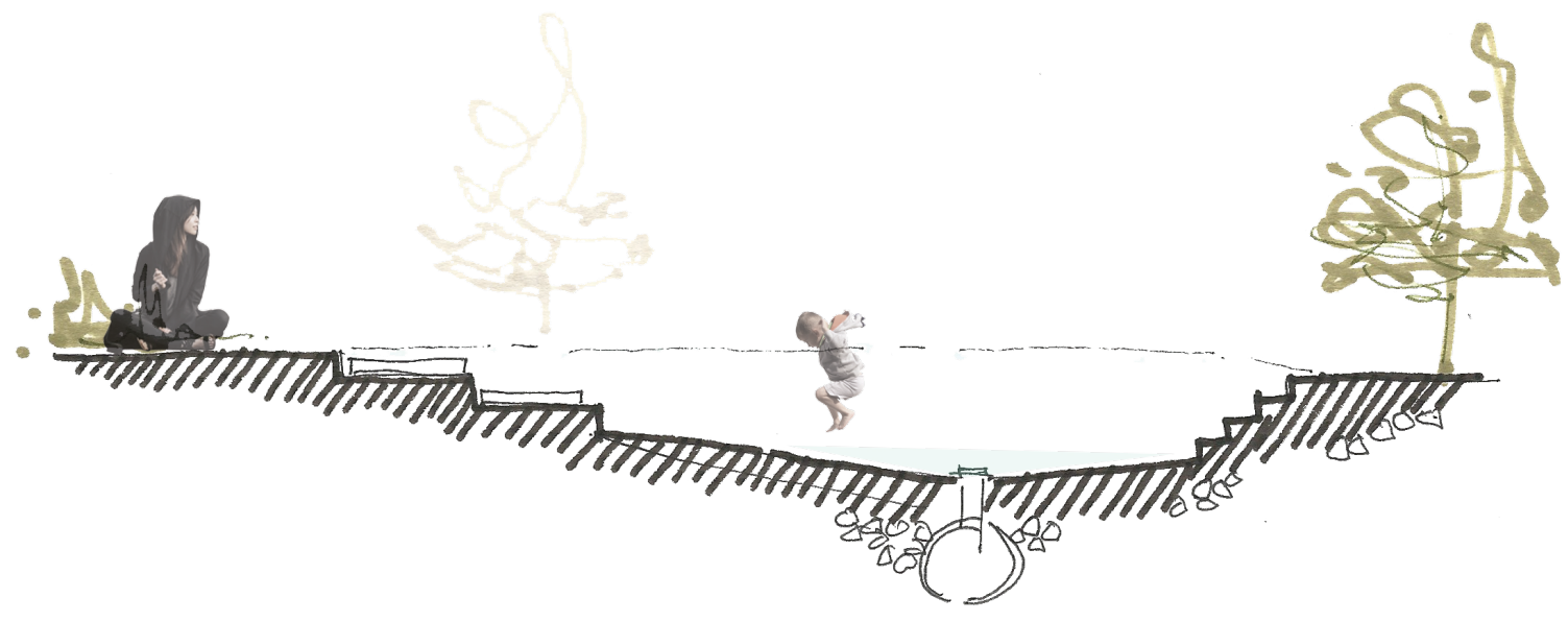
LE BASSIN DE RÉTENTION récupération vs espace diffusion /jeux
